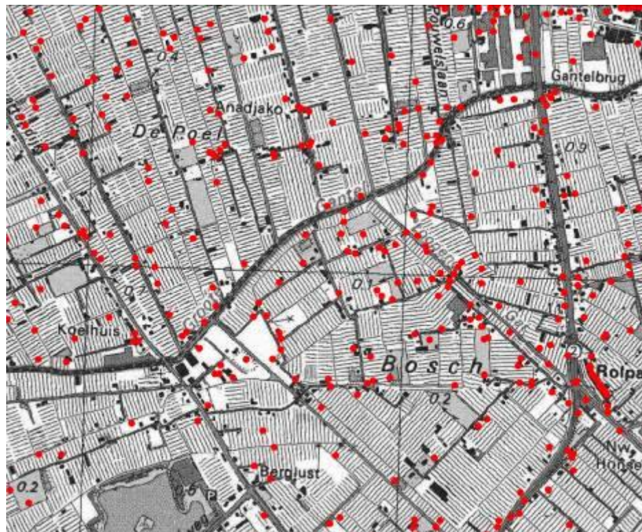
Figuur 1. Voorbeeld van de mutatieachterstand (de rode punten geven de met behulp van fotogrammetrie gesignaleerde mutaties aan).
